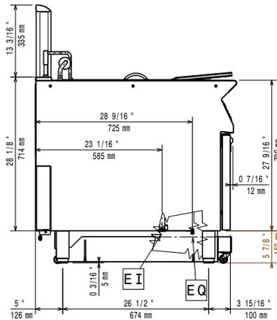
EI = Conexión eléctrica (energía)
